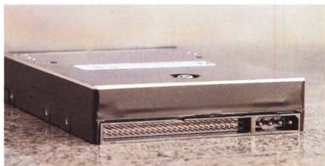
Il frontalino del drive Jaz occupa lo stesso spazio di un comune floppy disc drive da 3.5". Sul retro la connessione SCSI e l'alimentazione. La costruzione della meccanica molto accurata è evidenziata nella foto a lato.
